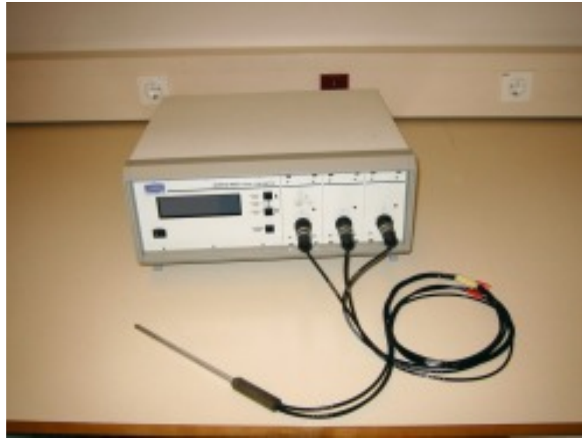
Un Gaussimetro, aparato para medir campos magnéticos.
