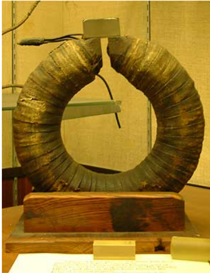
Aparato usado por Faraday para descubrir el efecto magnético óptico que lleva su nombre.
