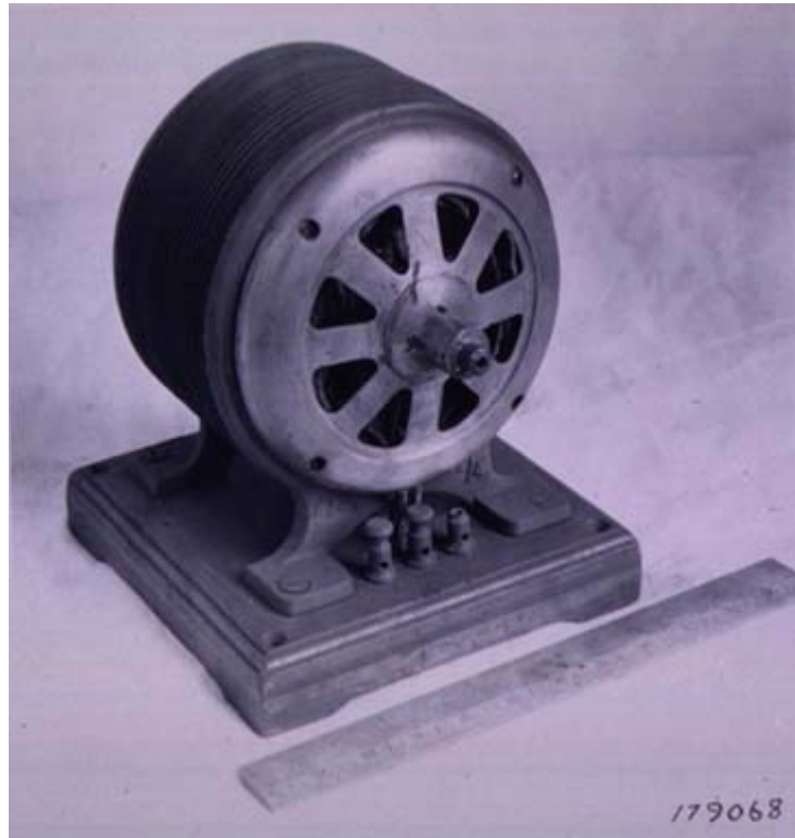
Uno de los primeros motores de inducción de Tesla, fabricados por Westinghouse Electric Co.
