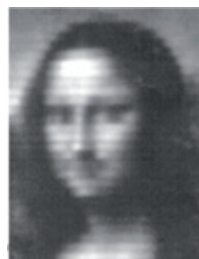
Figura 3. Mapa de fluencia generado sobre una película radiográfica modulando una haz de MV con un Elekta MLCi en una sola exposición de 1.5 min.
