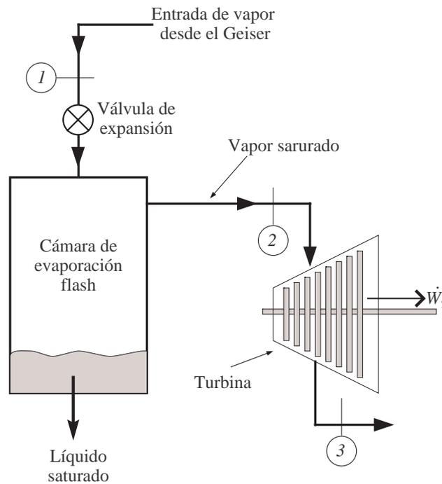
ayuda: Considere que la turbina está térmicamente aislada y relacione la cantidad de vapor que entra a la turbina con la calidad a la salida del evaporador "flash". Obtenga los datos necesarios de las tablas termodinámicas que se adjuntan.
