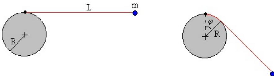
Sol: Escogemos como coordenada generalizada la longitud de la cuerda que no está enrollada  $l$ . En cada instante la cuerda se desenrolla girando en torno al punto de contacto. Se tiene:
