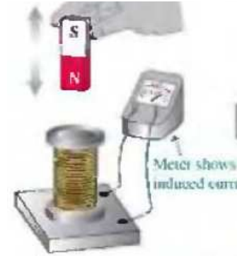
Figura 2. Al mover el imán se induce una corriente en la bobina.
