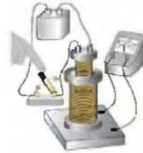
Figura 4. Al conectar o desconectar el circuito de la bobina interior, se induce una corriente en la bobina exterior.
