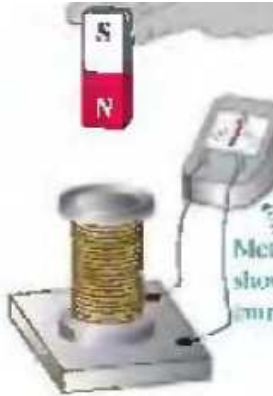
Figura 1. Un imán estacionario NO induce una corriente en la bobina.
