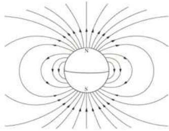
**Figura 11.** Líneas de campo de un dipolo eléctrico
