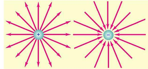
**Figura 10.** Campo Eléctrico de una carga puntual
