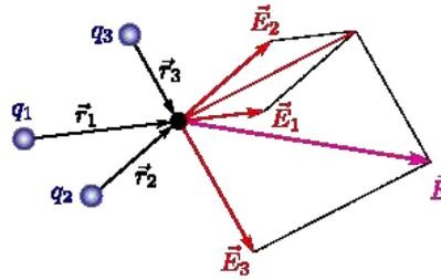
**Figura 9.** Campo eléctrico producido por un conjunto de cargas puntuales. Se muestra en rojo la suma vectorial de los campos de las cargas individuales;  $\vec{E} = \vec{E}_1 + \vec{E}_2 + \vec{E}_3$ .
