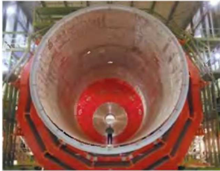
Figura 1. Este enorme cilindro es una bobina para generar campos magnéticos muy fuertes en el LHC en el CERN.
