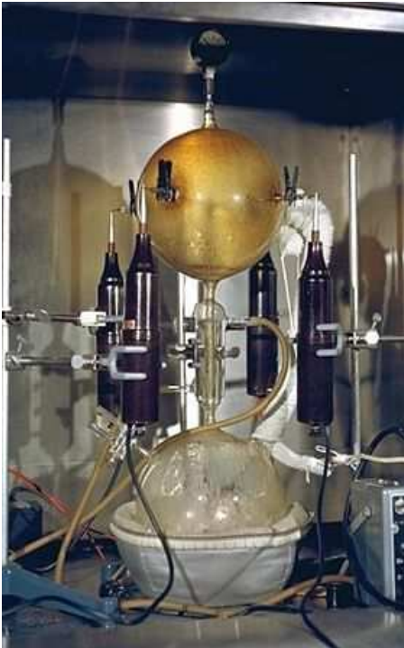
Instrumentos originales empleados para llevar a cabo el experimento de Miller y Urey
