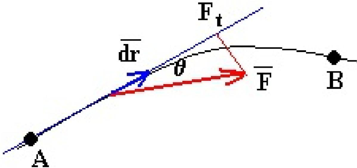
Donde  $F_t$  es la componente de la fuerza a lo largo del desplazamiento,  $ds$  es el módulo del vector desplazamiento  $dr$ , y  $\theta$  el ángulo que forma el vector fuerza con el vector desplazamiento.
