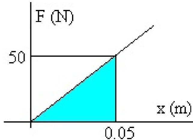
El área del triángulo de la figura es  $(0.05 \cdot 50)/2=1.25$  J
