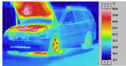
Figura 5. Termografía de un auto, donde se observan las diferentes temperaturas de sus partes.
