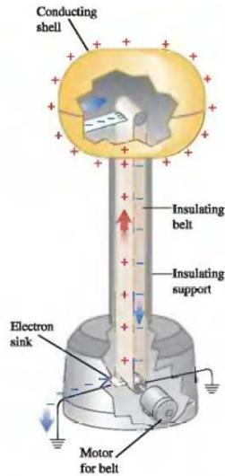
Los rodillos conectados por una banda aislante permiten transportar carga desde la región inferior donde se sacan electrones de la banda, con lo cual ésta queda cargada positivamente. En el rodillo superior, la banda entra en contacto con la superficie conductora, que recibe una carga positiva.
