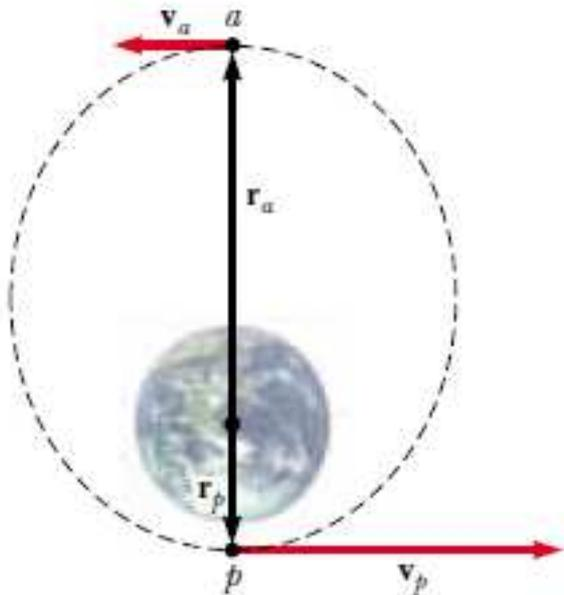
$$L_p = m v_p r_p = L_a = m v_a r_a$$
