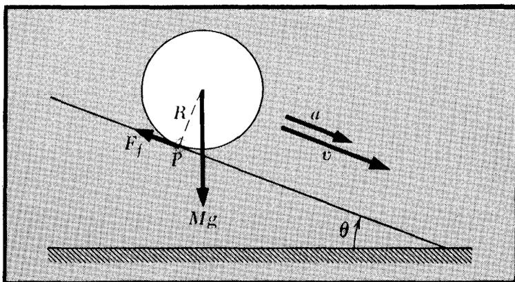
El carácter del movimiento de un cuerpo rodando es, en cualquier instante, la rotación alrededor del punto instantáneo de contacto P.
