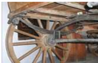
Figure 1: sistema de suspensión del “Pilentum”
