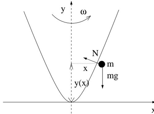
**Solución:** Las coordenadas de la masa son  $x$  e  $y(x)$  como se indica en la figura. Las fuerzas que actúan sobre la masa son su peso  $-mg\hat{j}$  y la reacción del alambre sobre ella  $\vec{N}$  (normal al alambre). Por otra parte, como vimos en clases, la aceleración de la masa (que está describiendo un círculo de radio  $x$  con velocidad angular uniforme  $\omega$ ) es centrípeta y está dada por  $\vec{a} = -\omega^2 x\hat{i}$ .
