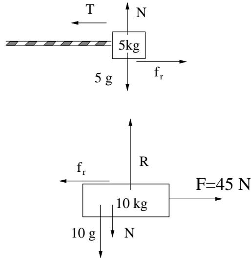
Sobre el bloque inferior actúan las siguientes fuerzas: la fuerza  $F = 45$  [N] hacia la derecha; el peso  $10g$  hacia abajo; la reacción del bloque superior  $N$  hacia abajo; la reacción del suelo sobre el bloque  $R$  y el roce entre los dos bloques, de magnitud  $f_r$  hacia la izquierda.
